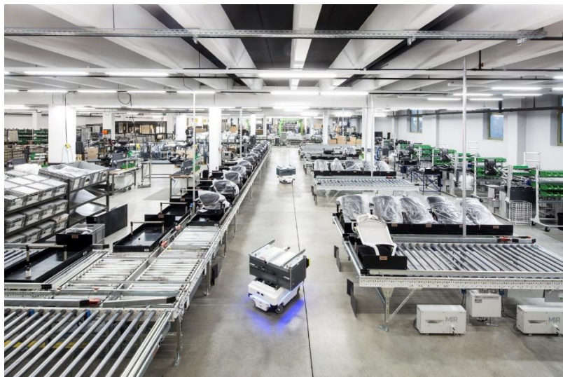
Abbildung 39: Smarte FTS an der neuen Produktionslinie Wagner
